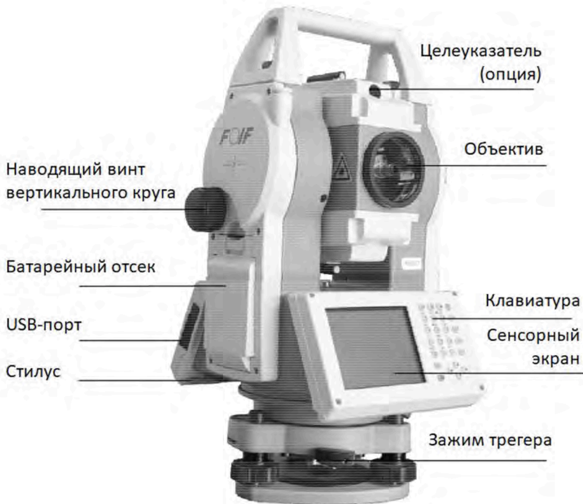
Рисунок 3 - Основные элементы тахеометра RTS362
