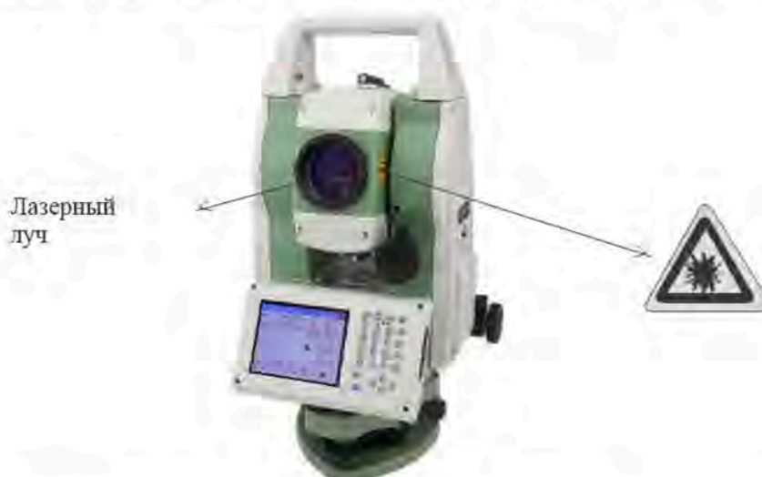
Рисунок 1 – Наклейки с оповещением об опасности лазерного излучения
