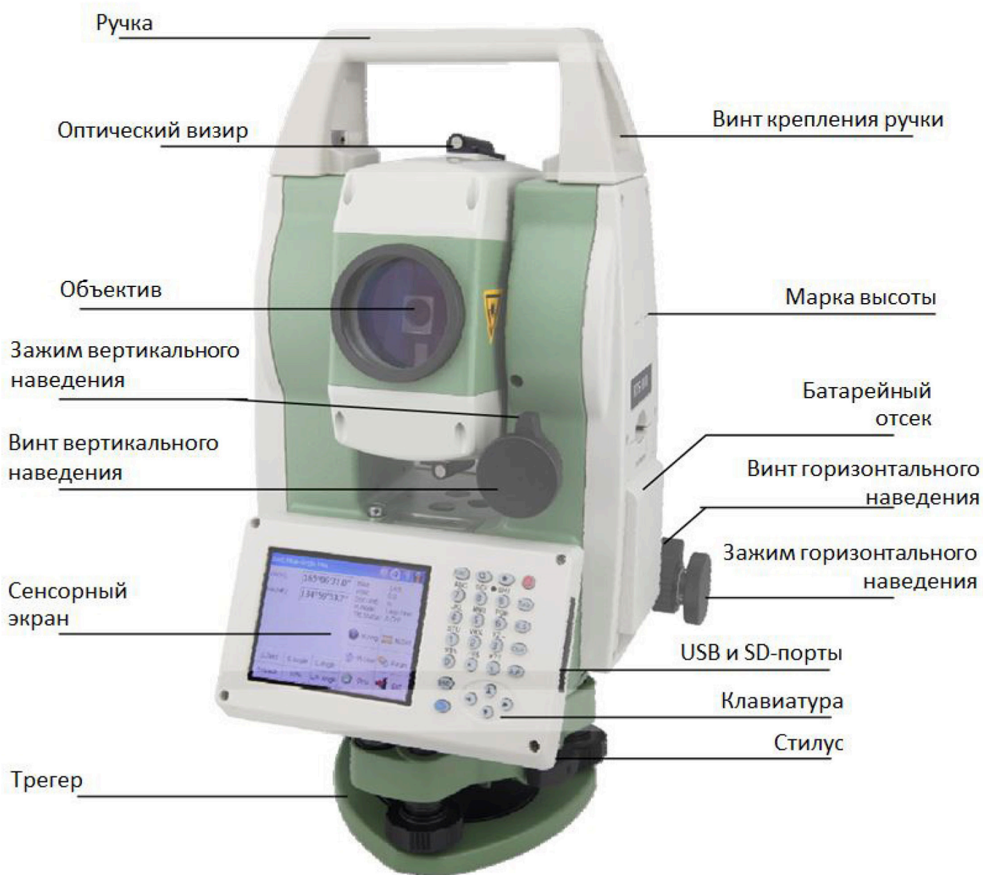
Рисунок 3 - Основные элементы тахеометра RTS010
