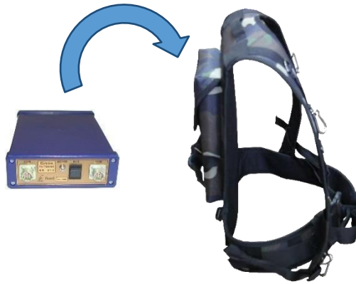
Рис. 2.3 - Размещение блока питания БП-9/12 в ременно-плечевой системе
