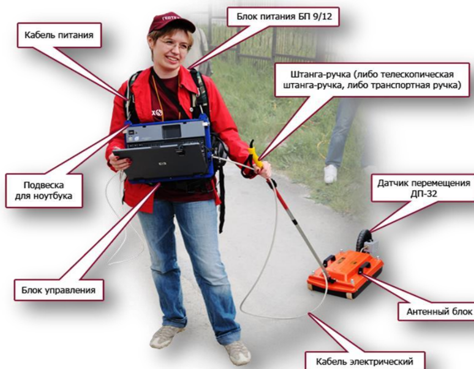
Рис. 1.5 - Оператор, экипированный для проведения пешеходной съемки с применением универсального базового комплекта и моноблока
