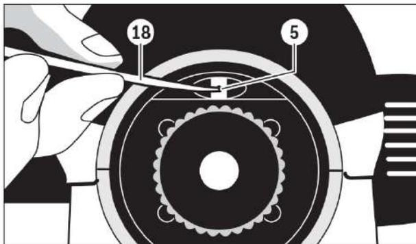
Открутите крышку окуляра **4**. С помощью стержня для настройки **18** поворачивайте юстировочный винт **5** по часовой стрелке/против часовой стрелки, пока при измерении на нивелирной рейке **B** не будет достигнуто рассчитанное значение высоты  $b_2$ .
