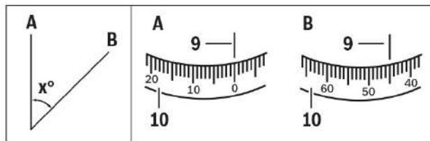
Направьте измерительный инструмент на точку **A**. Поверните горизонтальный лимб **10** нулевой точкой на отметку для считывания значений **9**. Направьте измерительный инструмент на точку **B**. Считайте значение угла по отметке для считывания значений **9**.
