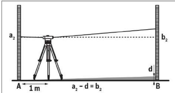
Установите измерительный инструмент на расстоянии ок. 1 м от нивелирной рейки **A**. После выравнивания и фокусировки измерительного инструмента считайте значение высоты  $a_2$  на нивелирной рейке **A**.
