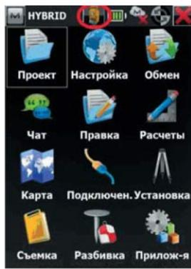
Переключение между данными, получаемыми с тахеометра и спутникового оборудования, закрепленного над круговой призмой, осуществляется одним нажатием стилуса на экране полевого контроллера при помощи функции «Гибридное переключение»
