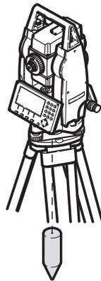
Направление действия силы тяжести. Компенсатор приводит ось вращения тахеометра в отвесное положение.
