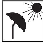
Тахеометр нужно защищать от прямых солнечных лучей, во избежание его нагрева. Не рекомендуется производить поверки при сильных колебаниях воздуха и атмосферной турбулентции. Наилучшие условия обычно рано утром или при затянутом облаками небе.
